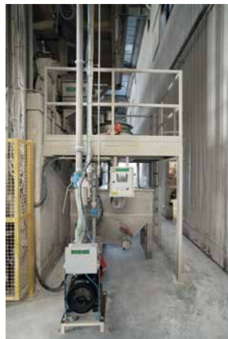
Pompa centrifuga di trasferimento barbotina da 1° a 2° o 3° modulo. Centrifugal pump for the slip transfer from 1 st to 2 nd or 3 rd module. Bomba centrífuga para la transferencia de la barbotina desde 1er hasta 2° o 3er módulo. Pompe centrifuge pour le transfert de la barbotine du 1 er au 2 nd ou 3 ème module. Bomba centrífuga de transferência barbotina de 1° a 2° ou 3° modulo.
