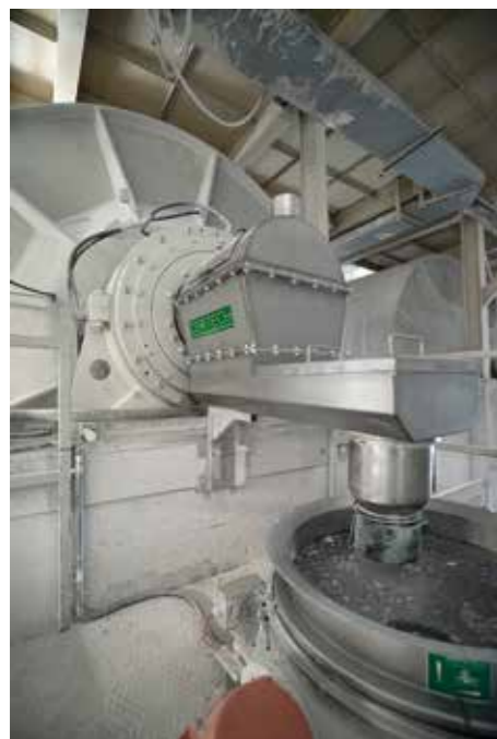
Dettaglio scarico barbotina primo modulo. Detail of slip unloading of first module. Detalle descarga barbotina primer módulo. Détail déchargement barbotine premier module. Detalhe descarga barbotina primeiro módulo.
