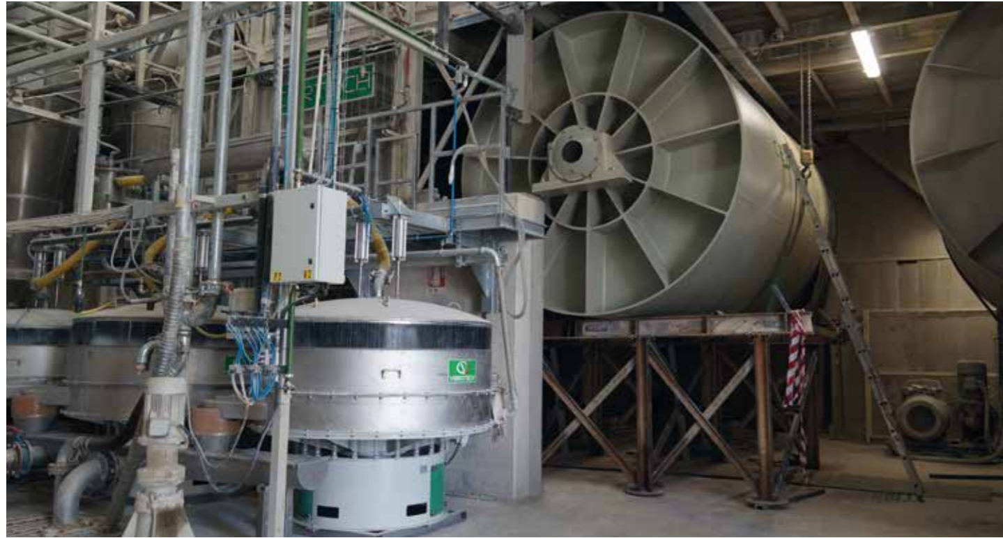
Molino raffinatore MCM 34.000 durante la fase di montaggio. MCM 34.000 refiner mill during the installation phase. Molino refinador MCM 34.000 durante la fase de instalación. Broyeur raffineur pendant la phase d'installation. Moinho refinador MCM 34.000 durante a fase de montagem.
