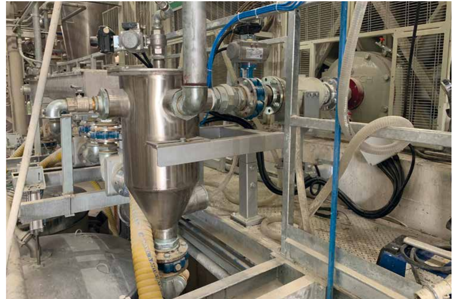
Dettaglio zona di scarico barbotina su mulino raffinatoro. Detail slip discharging area on refiner mill. Detalle de la zona de descarga barbotina en el molino refinador. Détail de la zone de déchargement des barbotines sur le broyeur raffineur. Detalle de la zona de descarga barbotina en el molino refinador.
