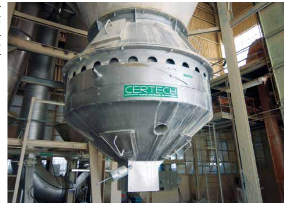
Raffreddatore per polvere atomizzata (punto 8). Cooler for spray-dried powder (point 8). Enfriador para polvo atomizado a instalar abajo del atomizador (punto 8). Refroidisseur pour poudre atomisée (point 8). Resfriador para pó atomizado (ponto 8).
