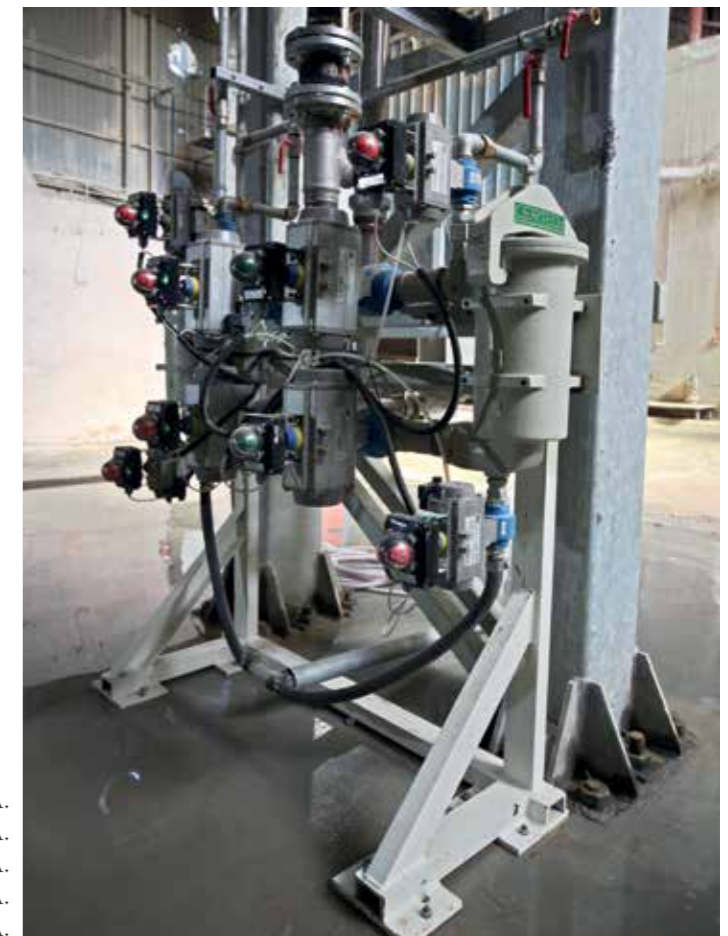
Pompe a pistoni per alimentazione atomizzatore. Piston pumps for the spray drier feeding. Bombas de pistones para alimentación atomizador. Pompes à pistons pour alimentation atomiseur. Bombas de pistão para alimentação do atomizador.
