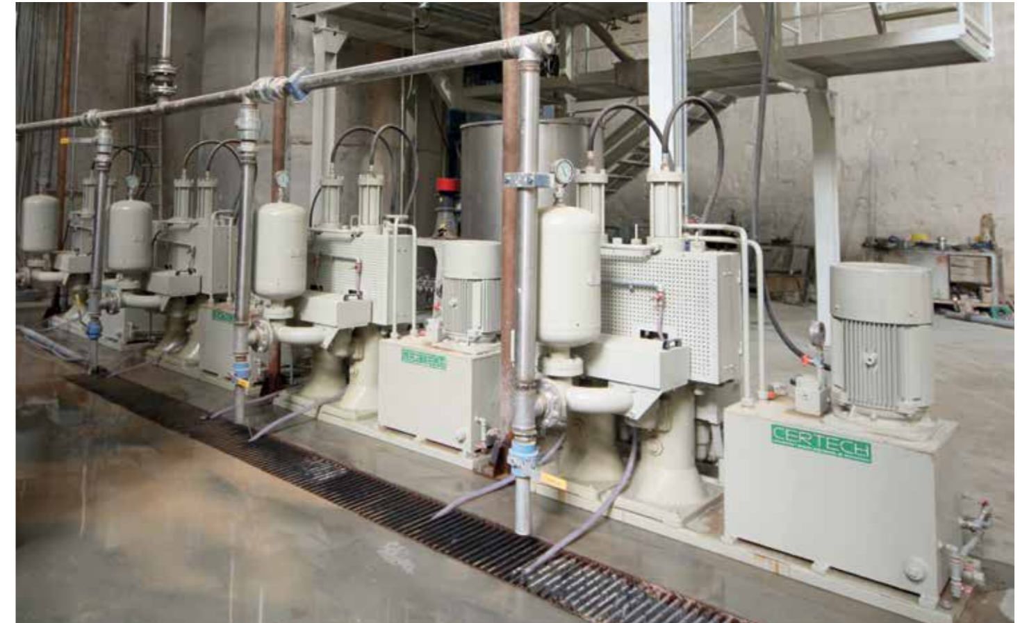
Pompe a pistoni per alimentazione atomizzatore. Piston pumps for the spray drier feeding. Bombas de pistones para alimentación atomizador. Pompes à pistons pour alimentation atomiseur. Bombas de pistão para alimentação do atomizador.
