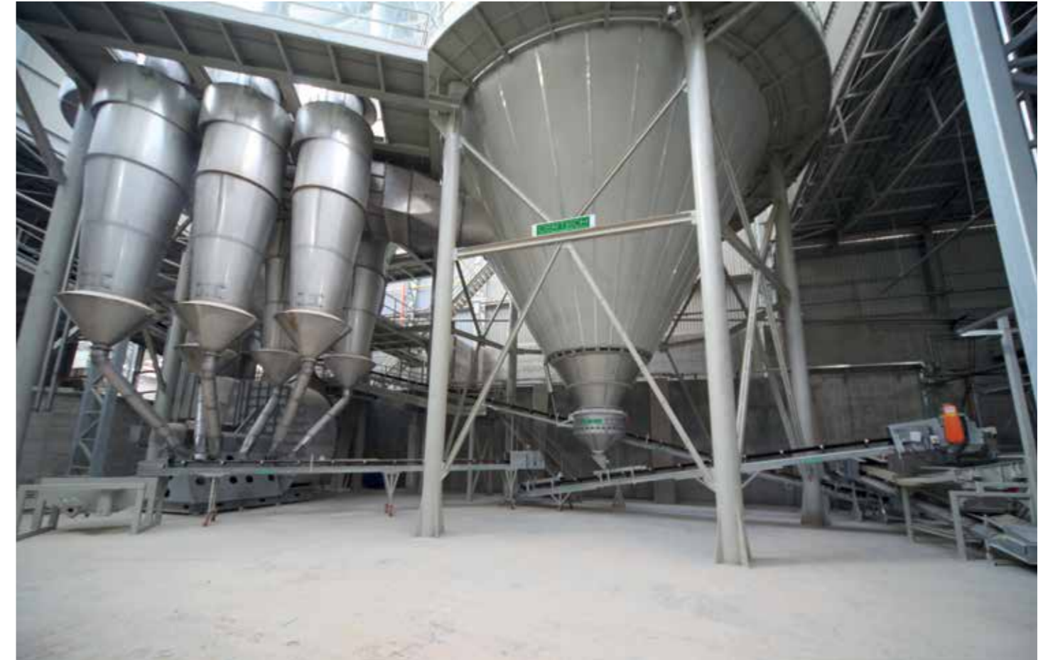
Atomizzatore CSD 20.000. CSD 20.000 spray drier. Atomizador CSD 20.000. Atomiseur CSD 20.000. Atomizadores CSD 20.000.
