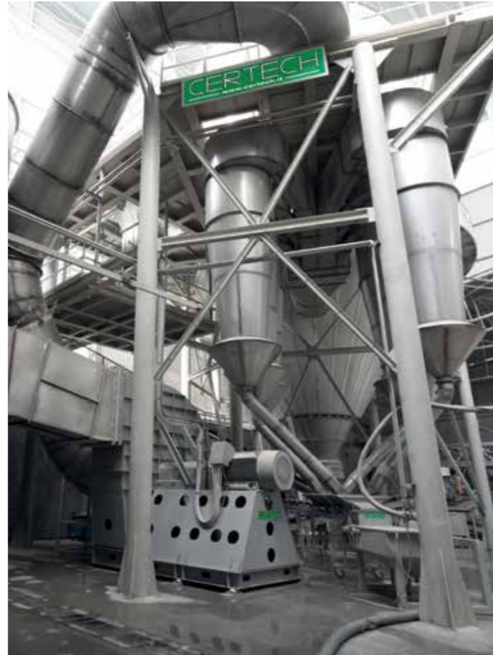
Atomizzatore tipo CSD 20.000 con torre di abbattimento ad umido. Spray drier type CSD 20.000 with wet scrubber tower. Atomizador tipo CSD 20.000 con torre de abatimiento de húmedo. Atomiseur type CSD 20.000 avec tour d'abattage par voie humide. Atomizador tipo CSD 20.000 com torre de depuração de modo úmido.
