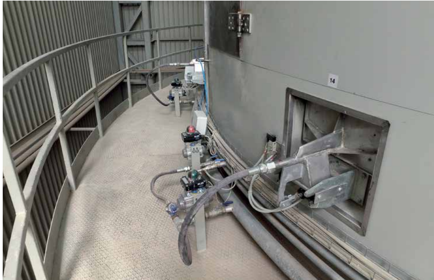
Lancia di spruzzatura dotata di sistema automatico per il lavaggio e lo scuotimento. Spraying lance equipped with automatic system for washing and shaking. Lanza de pulverización equipada con un sistema automático para lavado y sacudida. Lance de pulvérisation équipée d'un système automatique pour le lavage et le secouage. Lança de pulverização dotada de sistema automático para a lavagem e o batimento.
