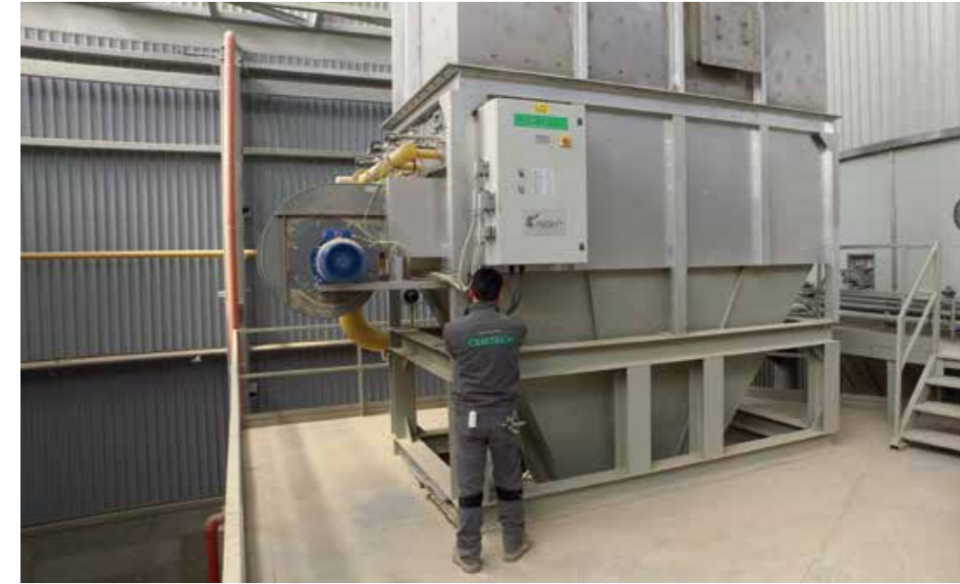
Bruciatore installato su atomizzatore CSD 18.000. Burner installed on CSD 18.000 spray drier. Queimador instalado en atomizador CSD 18.000. Brûleur installé sur atomiseur CSD 18.000. Queimador instalado no atomizador CSD 18.000.
