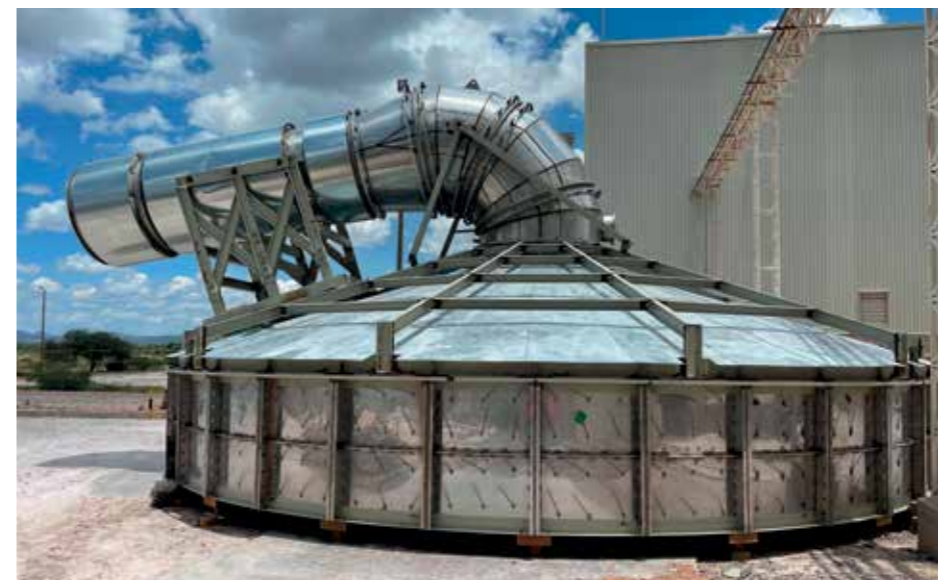
Cappello diametro 12.000 mm con entrata aria calda centrale e porzione di cilindro H: 1500 mm. Hat diameter 12.000 mm with central hot air inlet and cylinder portion H: 1500 mm. Cabeza diámetro 12.000 mm con entrada de aire caliente central y porción de cilindro H: 1500 mm. Chapeau diamètre 12.000 mm avec entrée air chaud centrale et portion de cylindre H : 1500 mm. Chapéu diâmetro 12.000 mm com entrada de ar quente central e porção de cilindro H: 1500 mm.
