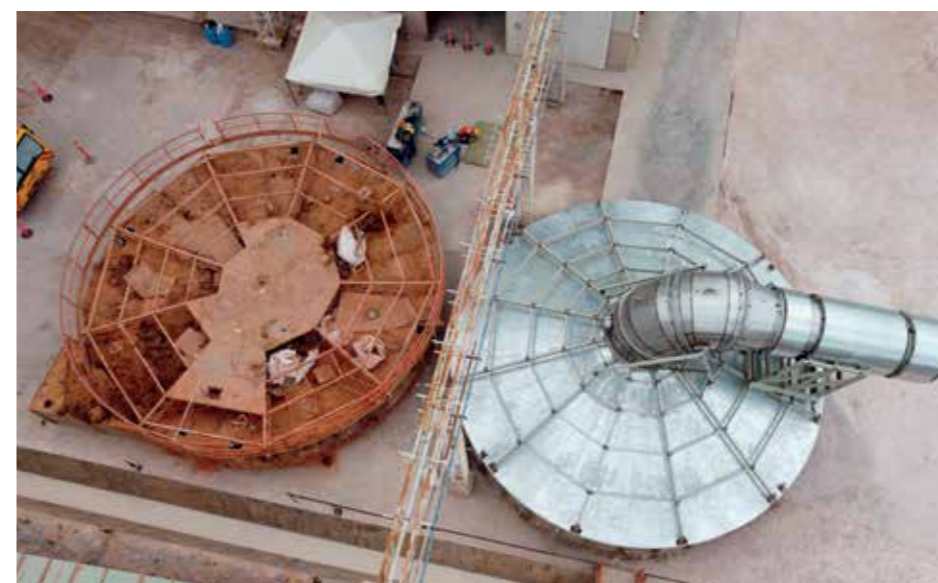
Prima e dopo. Cappello con ingresso aria calda tangenziale vs cappello con ingresso aria calda centrale. Before and after. Hat with tangential hot air inlet vs hat with central hot air inlet. Antes y después. Sombrero con entrada aire caliente tangencial / sombrero con entrada aire caliente central. Avant et après. Chapeau avec entrée d'air chaud tangentielle vs chapeau avec entrée d'air chaud centrale. Antes e depois. Chapéu com entrada de ar quente tangencial vs chapéu com entrada de ar quente central.
