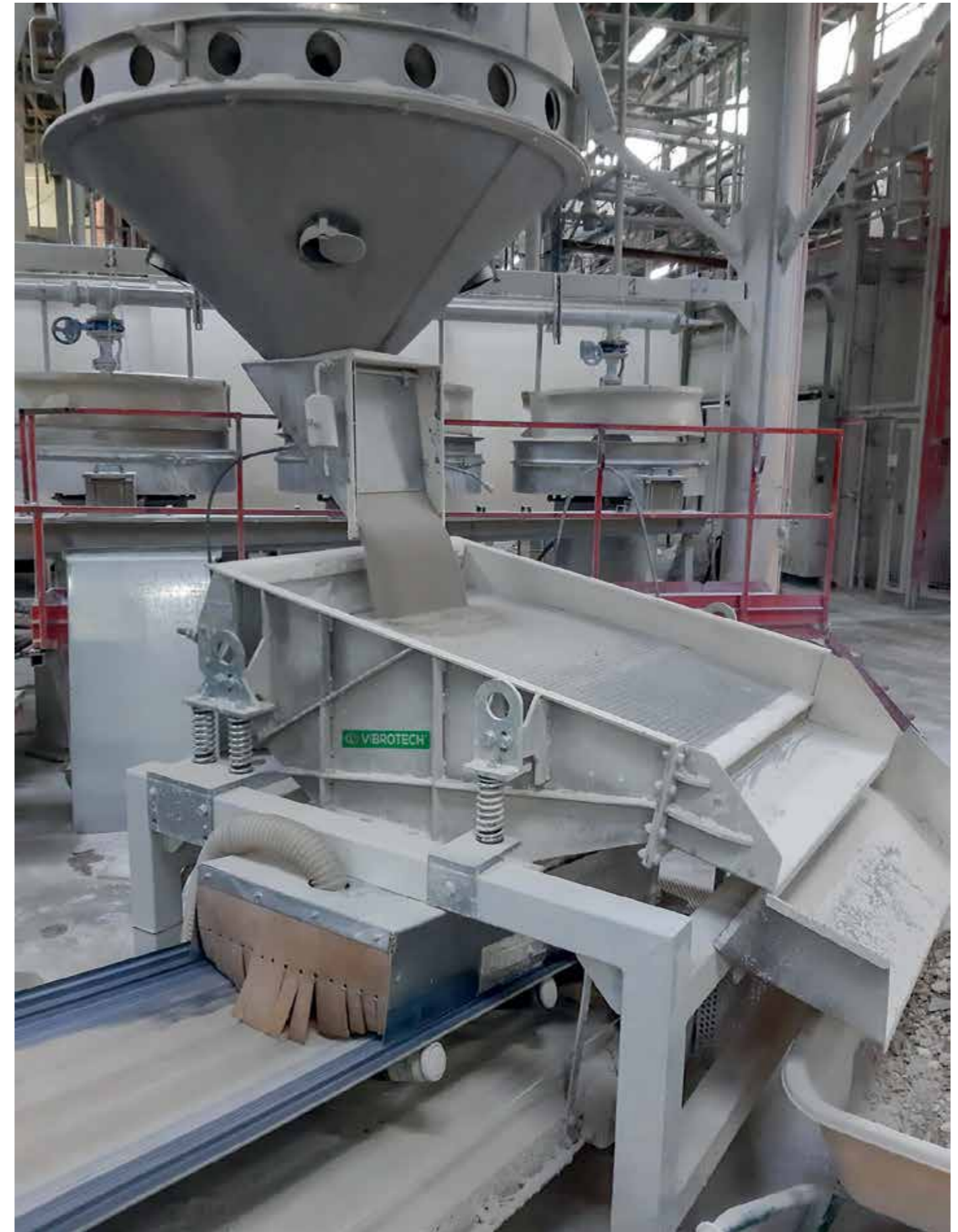
Dettaglio di raffreddatore per polvere atomizzata e di nostro setaccio SET 700. Detail of a cooler for spray dried powder and of our SET 700 screen. Detalle de enfriador para polvo atomizado y de nuestro tamiz SET 700. Détail d'un refroidisseur pour poudre atomisée et de notre tamis SET 700. Detalhe do resfriador para pó atomizada e nossa peneira SET 700.
