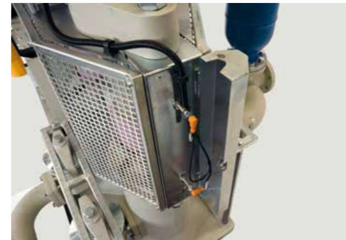
Sistema elettronico per la gestione dello scambio dei pistoni tuffanti. Electronic system for the control of the plunger pistons exchange. Sistema electrónico para el control del intercambio de los pistones sumergidos. Système électronique pour le control de l'échange des pistons plongeurs. Sistema eletrônico para a gestão da troca de pistões de mergulho.
