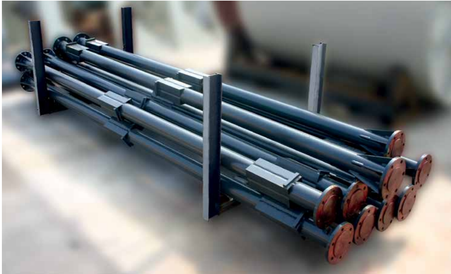
Alberi in acciaio al carbonio, verniciati con vernice epossidica in stock. Carbon steel shafts, painted with epoxy paint in stock. Ejes en acero al carbono, pintados con pintura epoxídica en stock. Arbres en acier au carbone, vernis avec peinture époxy en stock. Eixos em aço carbono, pintados com tinta epoxídica em estoque.
