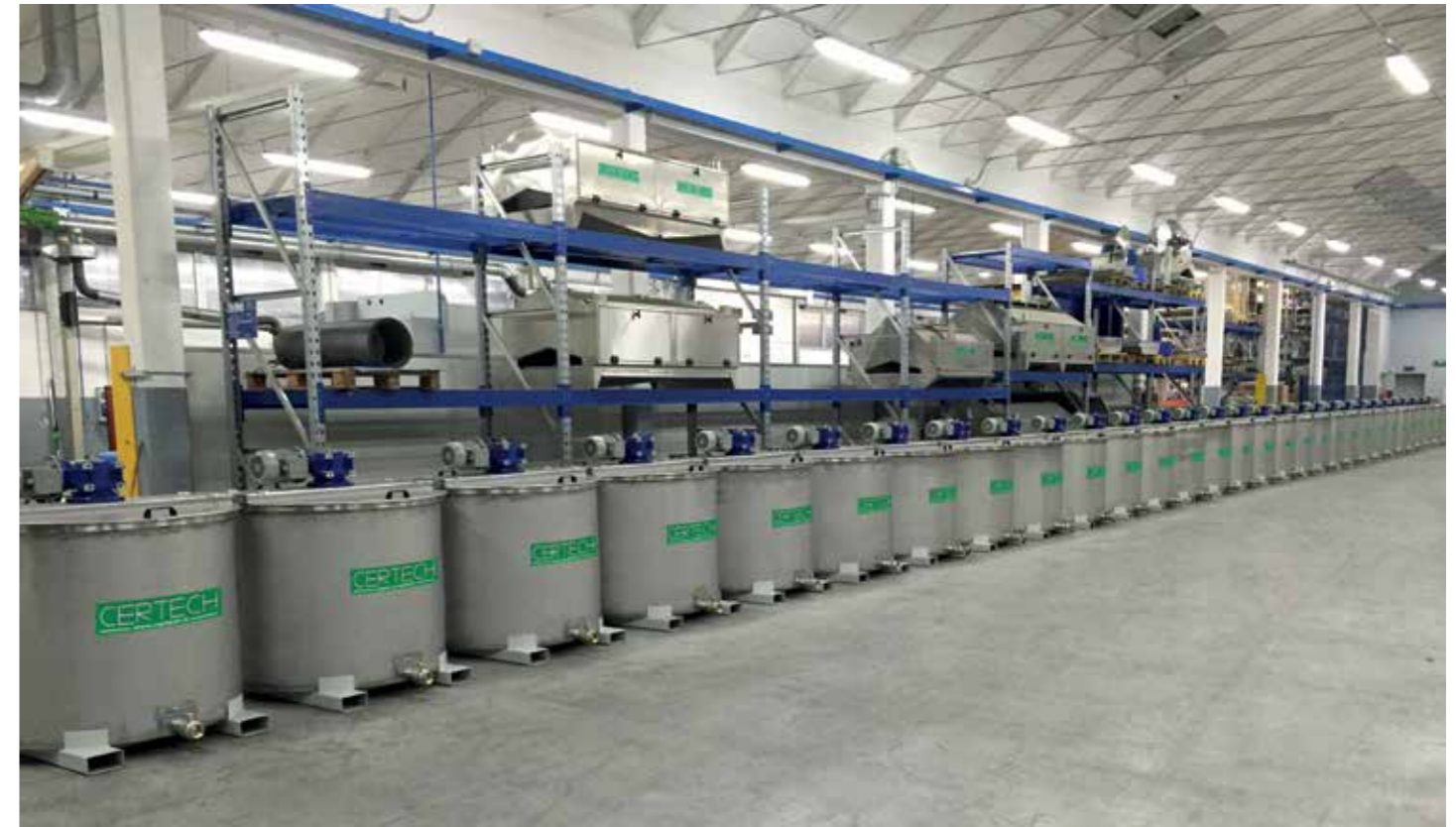
Batteria di vasche costruite in acciaio inox con agitatore a rastrello. Tanks batch built in stainless steel with rake stirrer. Batería de tanques construidas en acero inoxidable con agitador de rastrollo. Batterie de cuves construites en acier inoxydable avec agitateur à râteau. Bateria de tanques fabricados em aço inox com agitador de forquilha.
