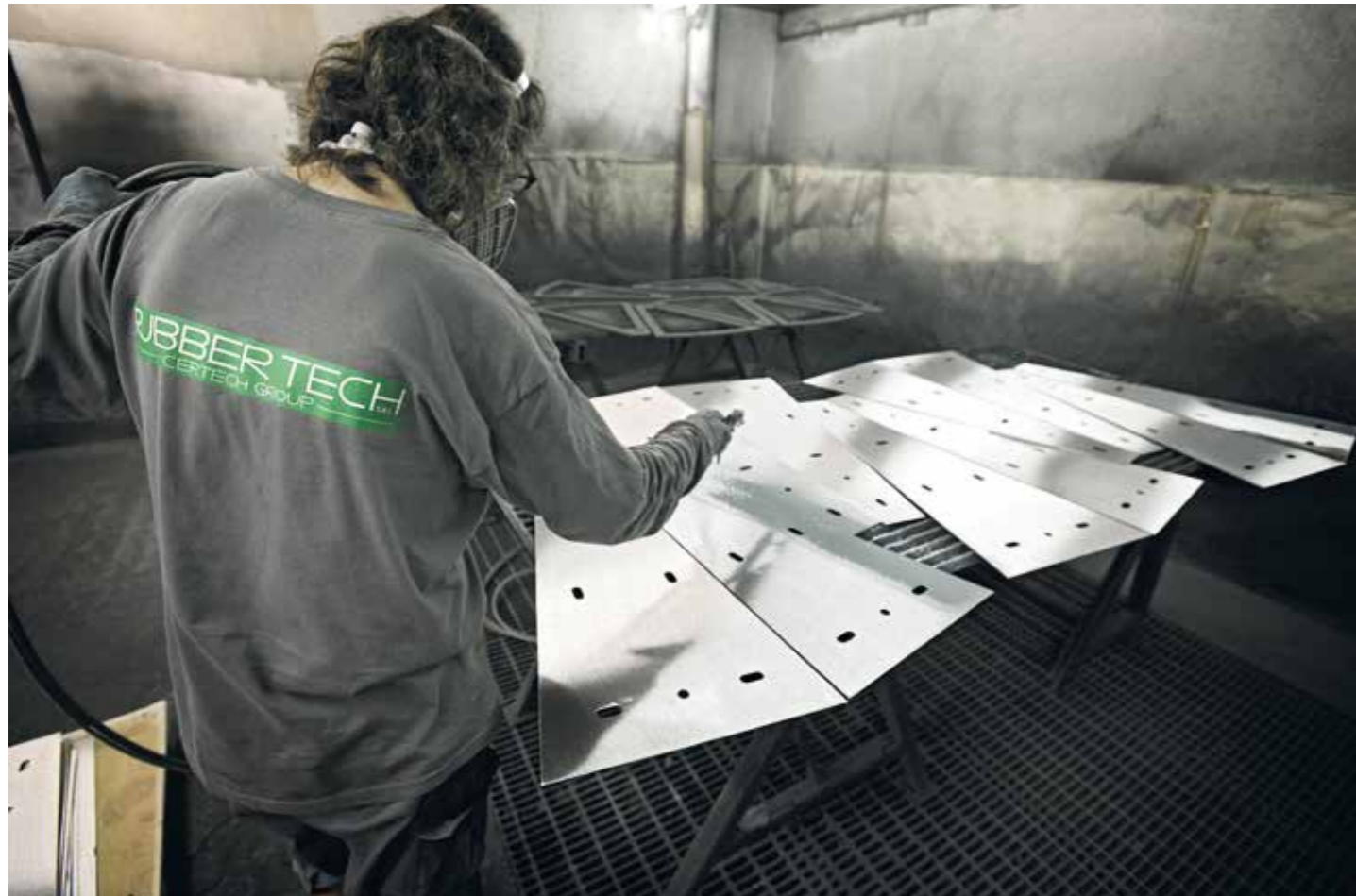
Applicazione prodotto aggrappante sui supporti metallici. Application of gripping agent on metal supports. Aplicación del producto de fijación a los soportes metálicos. Application produit d'accrochage sur les supports métalliques. Aplicação produto adesivo nos suportes metálicos.
