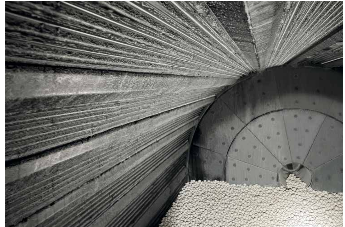
Dettagli di rivestimento in gomma tipo ROTEX STRONG. Details of the ROTEX STRONG rubber lining. Detalles de revestimiento de goma tipo ROTEX STRONG. Détails du revêtement en caoutchouc type ROTEX STRONG. Detalhes do revestimento de borracha tipo ROTEX STRONG.
