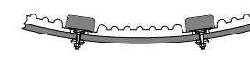
Rivestimento cilindro secondo, terzo e quarto modulo. 2nd - 3rd and 4th Module cylinder lining. Revestimiento cilindro segundo, tercero y cuarto modulo. Rev4tement cylindre deuxi4me, troisi4me et quatri4me module. Revestimento do cilindro segundo, terceiro e quarto m3dulo.
