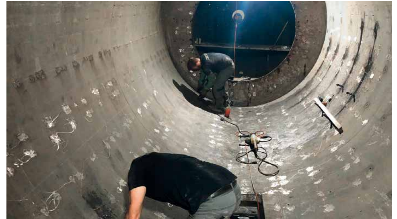
Foratura cilindro mulino 100.000 lt. Cylinder perforation 100.000 Lts mill. Perforación cilindro molino 100.000 Lts. Perforation cylindre broyeur 100.000 Lt. Furação cilindro moinho 100.000 l
