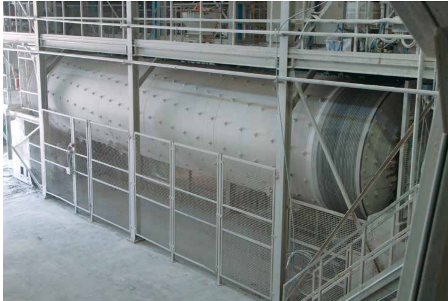
Molino continuo classificante con capacità di 60.000 litri. Continuous sorting mill with a capacity of 60,000 litres. Molino continuo clasificante con capacidad de 60.000 litros. Moulin continu de classification doté d'une capacité de 60 000 litres. Moinho continuo classificante com capacidade de 160.000 litros.
