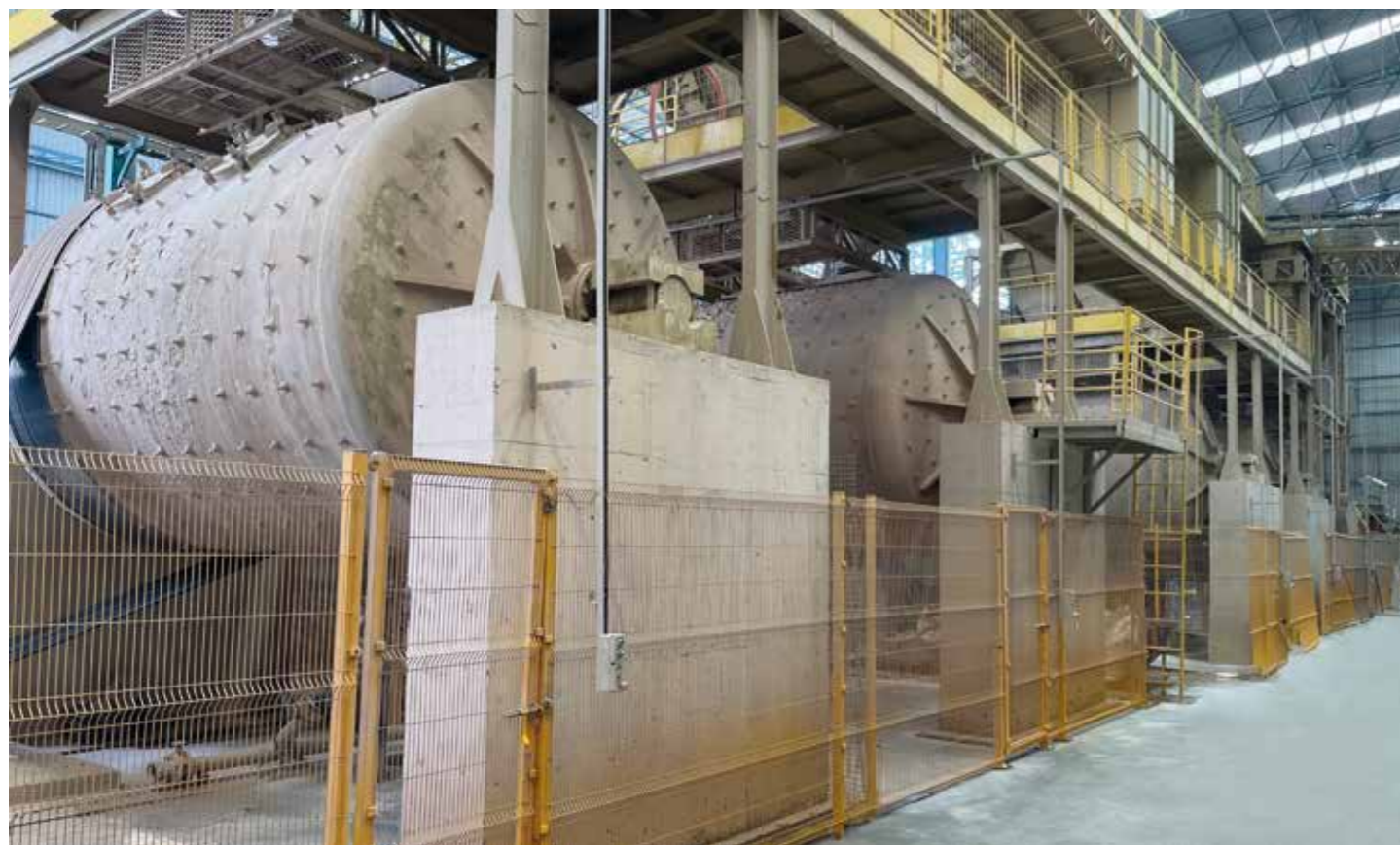
Batteria di mulini discontinui con fondi bombati. Set of discontinuous mills with rounded bottom heads. Bateria de molinos discontinuos con fondos abombados. Batterie de moulins discontinus avec fonds bombés. Bateria de moinhos descontinuos com fundos arredondados.
