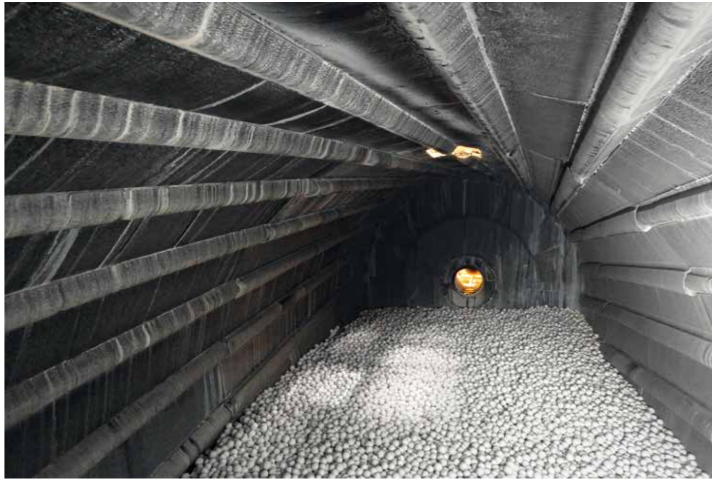
Vista interna della prima camera di un mulino continuo classificante con capacità di 80.000 litri. Internal view of the first chamber of a continuous sorting mill with a capacity of 80,000 litres. Vista interna de la primera cámara de un molino continuo clasificador con capacidad de 80.000 litros. Vue interne de la première chambre d'un moulin continu de classification doté d'une capacité de 80 000 litres. Vista interna da primeira câmara de um moinho contínuo classificante, com capacidade de 80.000 litros.
