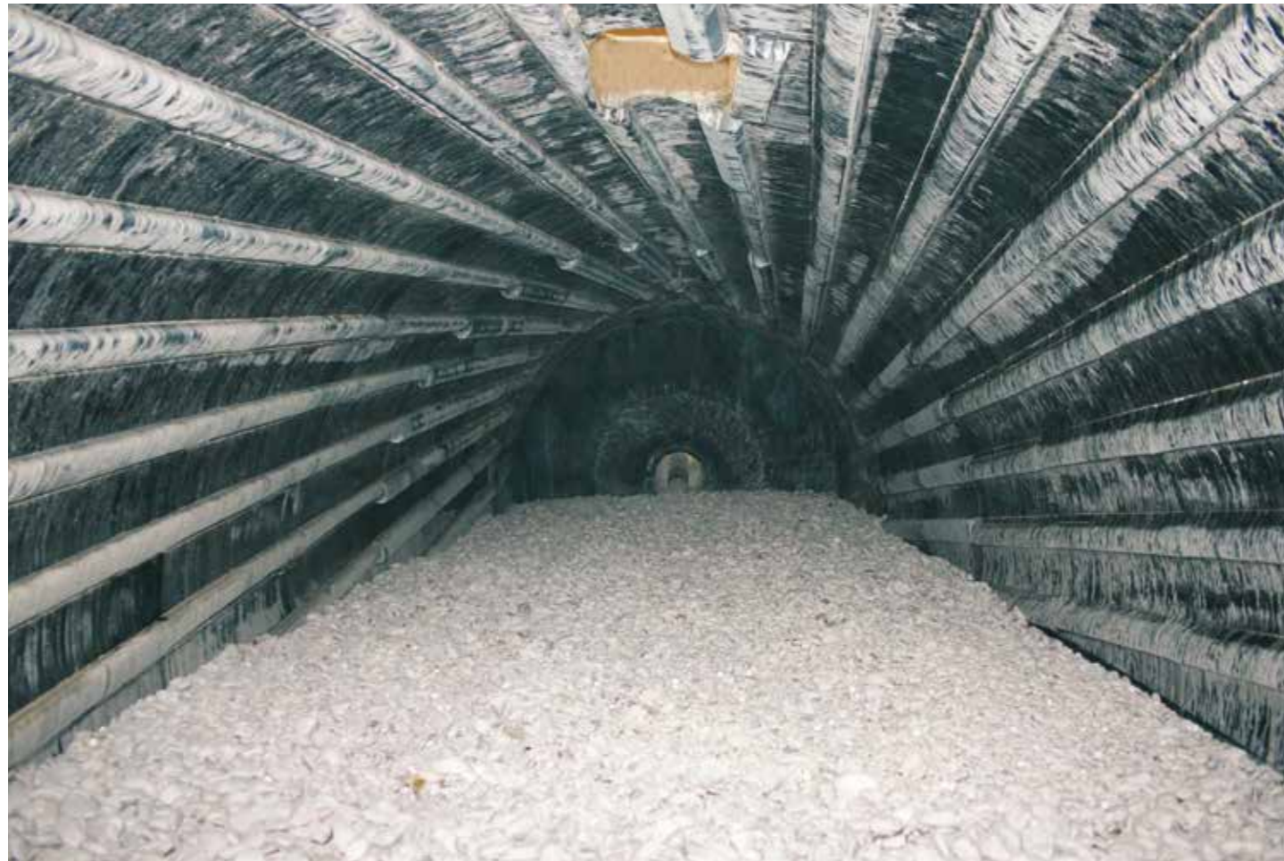
Vista interna della prima camera di un mulino continuo classificante con capacità di 160.000 litri. Internal view of the first chamber of a continuous sorting mill with a capacity of 160,000 litres. Vista interna de la primera cámara de un molino continuo clasificante con capacidad de 160.000 litros. Vue interne de la première chambre d'un moulin continu de classification doté d'une capacité de 160 000 litres. Vista interna da primeira câmara de um moinho contínuo classificante com capacidade de 160.000 litros.
