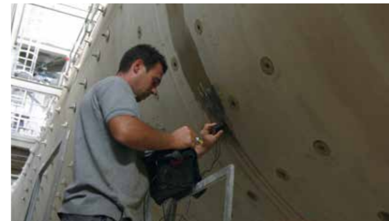
Controllo strutturale del cilindro del mulino con ultrasuoni. Structural testing of the mill cylinder with ultrasound. Control estructural del cilindro del molino con ultrasonidos. Contrôle de la structure du cylindre du broyeur par le biais d'ultrasons. Control estrutural del cilindro del molino con ultrasonidos.
