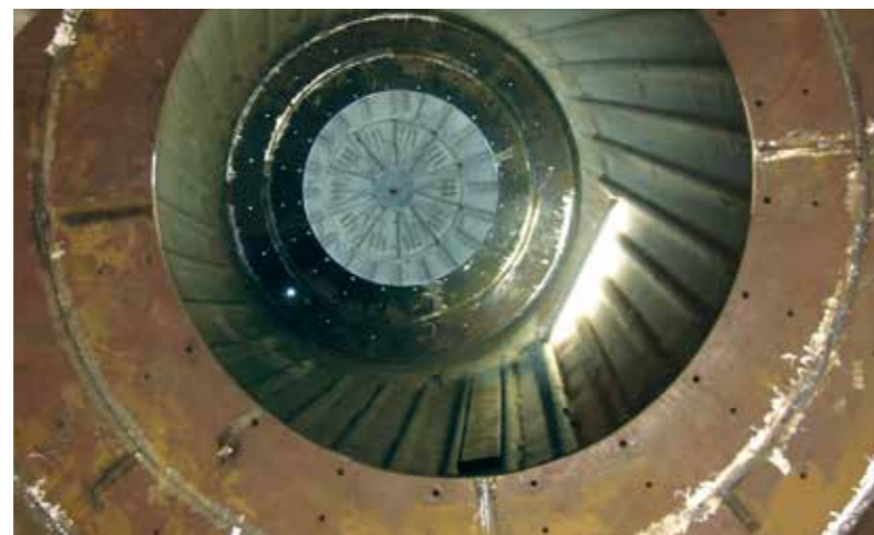
Assemblaggio di n. 2 anelli in acciaio all'interno del mulino. Assembly of the 2 steel ring inside the mill. Ensamblaje de nr. 2 anillos en acero en el interior del molino. Assemblage de nr. 2 anneaux en acier à l'intérieur du broyeur. Montagem de 2 anéis de aço no interior do moinho.
