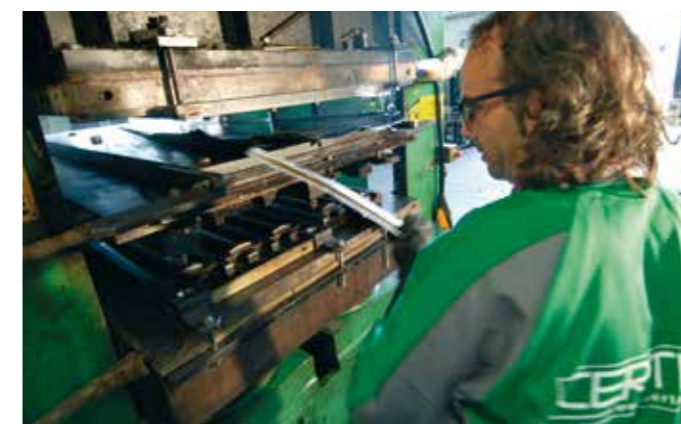
Pressa a due piani in fase di apertura. Two-level press during the opening stage. Prensa de dos planos en fase de apertura. Presse à deux étages en phase d'ouverture. Prensa de dois planos em fase de abertura.
